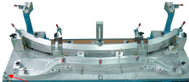
Util de control equipado con argollas de manipulación
