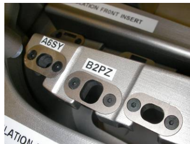
Pegatinas identificando RPS del útil de control (primer plano) así como un taco desmontable (segundo plano)
