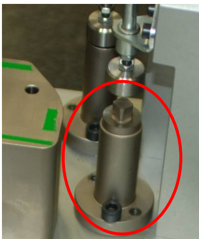
Centrador rombocónico, que permite centrar la pieza en un sentido
