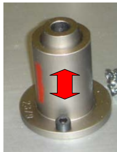
Centrador cónico, que permite centrar la pieza por uno de sus agujeros; la forma del centrador permite absorber la tolerancia de fabricación del agujero, y asegurar así un centraje óptimo
