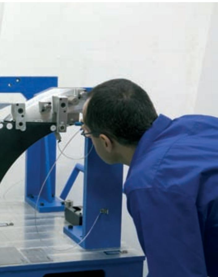
Tecnomatrix está especializada en el desarrollo de utilajes de control dimensional para piezas de automóviles./Tecnomatrix specialises in developing dimensional-control tooling for automobile parts.
